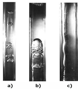
Figura 4.17: Confronto tra gli effetti di diversi flussi d'aria sulla distribuzione delle bolle all'interno della membrana (doc. Pentair).
